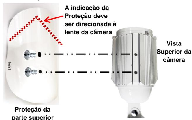
3. Após da fixação da Parte Superior na câmera solte o parafuso Allen na parte direita da câmera, alinhe a câmera para o ângulo vertical desejado e sem seguida aperte o parafuso novamente para fixar a posição. Em seguida solte o parafuso Allen na parte de baixo do suporte, alinhe a câmera para o ângulo horizontal desejado e em seguida aperte o parafuso novamente para fixar a posição.
